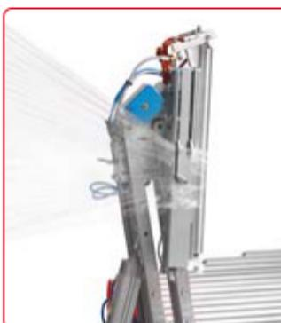
**It** Sistema di pinza taglio saldatura del film estensibile autoregolante per vari dimensione del pallet.
